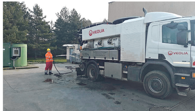
Wykorzystanie wody technologicznej na stacji zlewnej do odbioru nieczystości ciekłych z pojazdów asenizacyjnych
