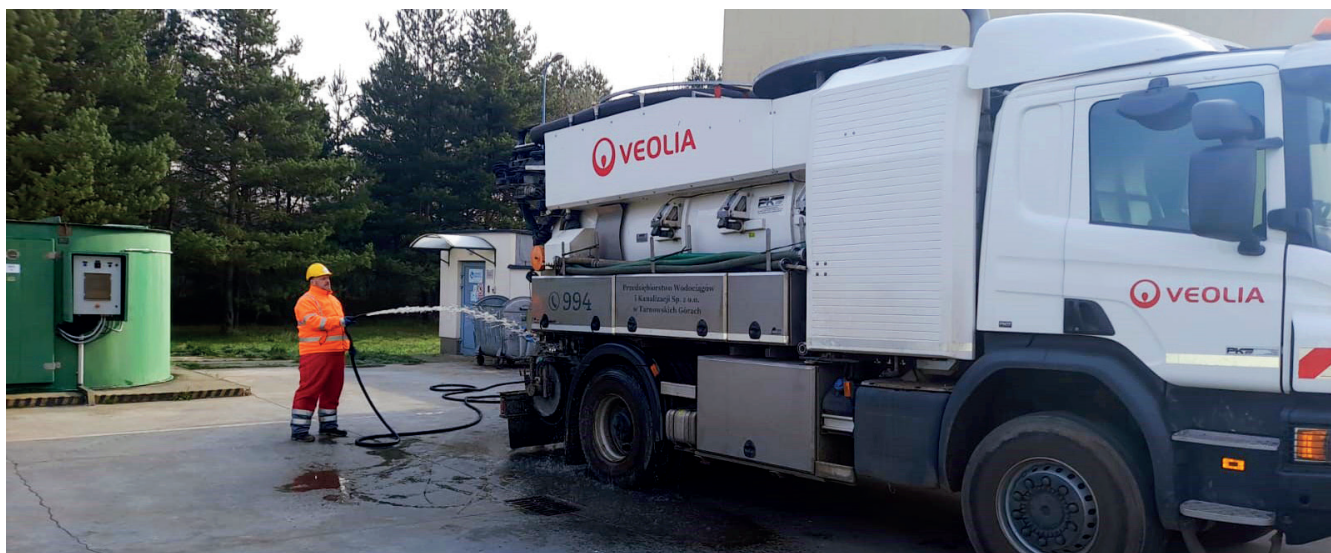
Wykorzystanie wody technologicznej na stacji zlewnej do odbioru nieczystości ciekłych z pojazdów asenizacyjnych
